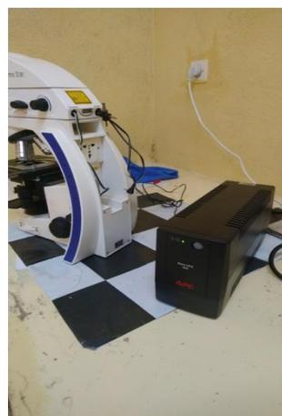
L'onduleur d'origine du microscope à fluorescence ne permet plus une utilisation correcte (lumière clignotante). Un nouvel onduleur a été acheté pour le remplacer
