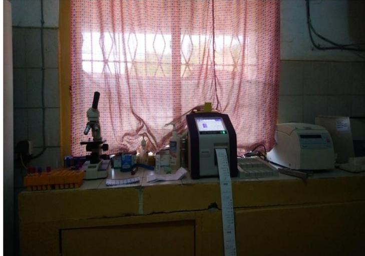
Le laboratoire du CDN est situé dans une petite pièce. Un technicien présent tous les jours dispose d'un microscope et d'un automate, le BD Fasts Presto qui permet la quantification des CD4 et de l'hémoglobine totale.
